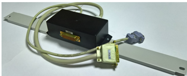
Разветвитель КБС-БКС: (для установки в стойку АГО «РИКОМ»-03)
