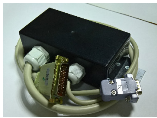
Разветвитель КБС-БКС: (для установки в шкаф АГО «РИКОМ»-06)
